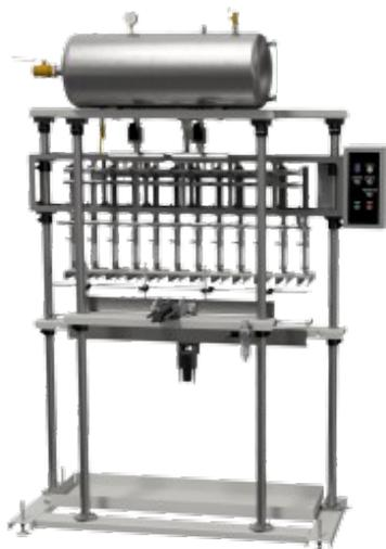
Автомат предназначен для фасования газированных напитков в бутылки из полиэтилентерефталата (ПЭТ-тару).
