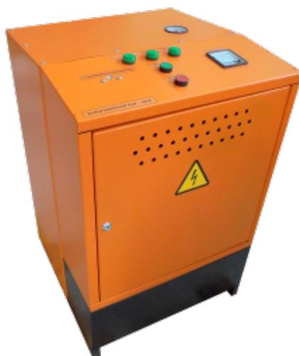
Парогенератор электрический электродный предназначен для выработки насыщенного водяного пара с температурой 130-160 °С и давлением до 0,55 МПа за счет теплоты, выделяющейся в результате использования электроэнергии.
