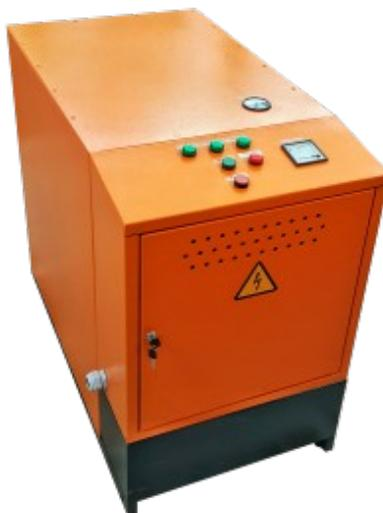
Парогенератор электрический ТЭНовый предназначен для выработки насыщенного водяного пара с температурой 130-160 °С и давлением выше атмосферного за счет теплоты, выделяемой нагревом блок-ТЭНов.
