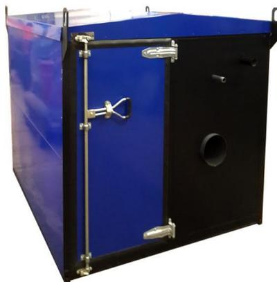
Парогенератор мобильный ПГМ-0,2 изготовлен в виде теплоизолированного контейнера, который оснащен баком для питательной воды и дизельного топлива. Объем баков рассчитан на непрерывную работу парогенератора в течение 3-4 часов без дозаправки.
