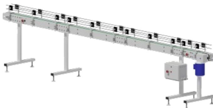
*Транспортировочные конвейеры для бутылок используются в составе автоматизированных линий для перемещения в горизонтальной плоскости бутылочной тары.*
