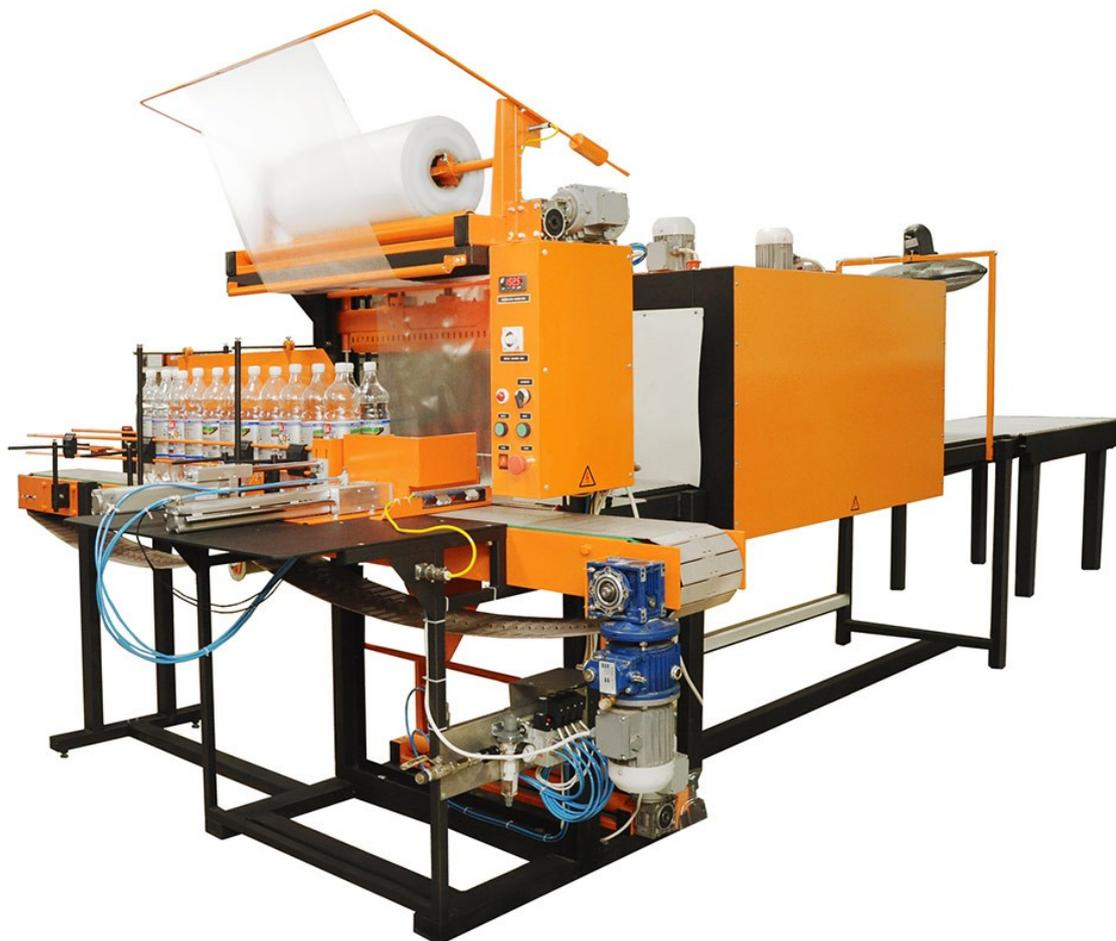
Термоупаковочная машина ТМ-1А (автомат) предназначена для автоматической групповой упаковки в термоусадочную пленку пищевой, косметической или иной продукции в стеклянной, металлической, бумажной или пластиковой таре.
