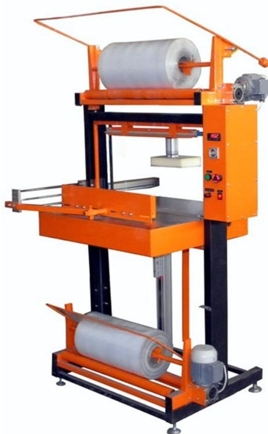
Термонож пневматический ТМ-1П предназначен для штучной и групповой упаковки различных видов продукции в полиэтиленовую термоусадочную пленку. Толкатель термоножа регулируется под габариты продукции, что дает возможность увеличить перечень упаковываемого товара.
