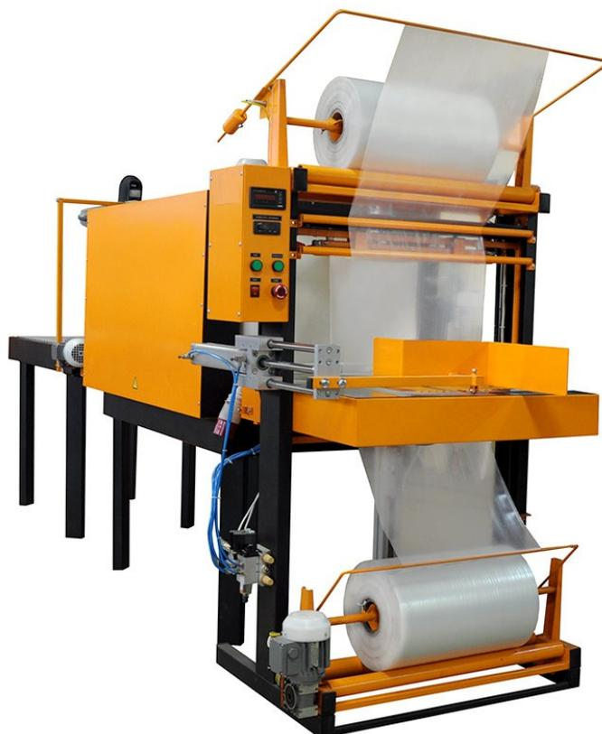
Термоупаковочная машина ТМ-1ПА предназначена для упаковки канистр, коробов, ПЭТ тары в термоусадочную полиэтиленовую пленку.
