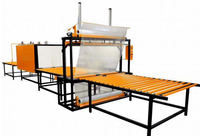
Термоупаковочная машина ТМ-1ПН МЗ (пневмонож) предназначена для упаковки товара с максимальным размером ДхШхВ 2150х760х700 в термоусадочную полиэтиленовую пленку.
