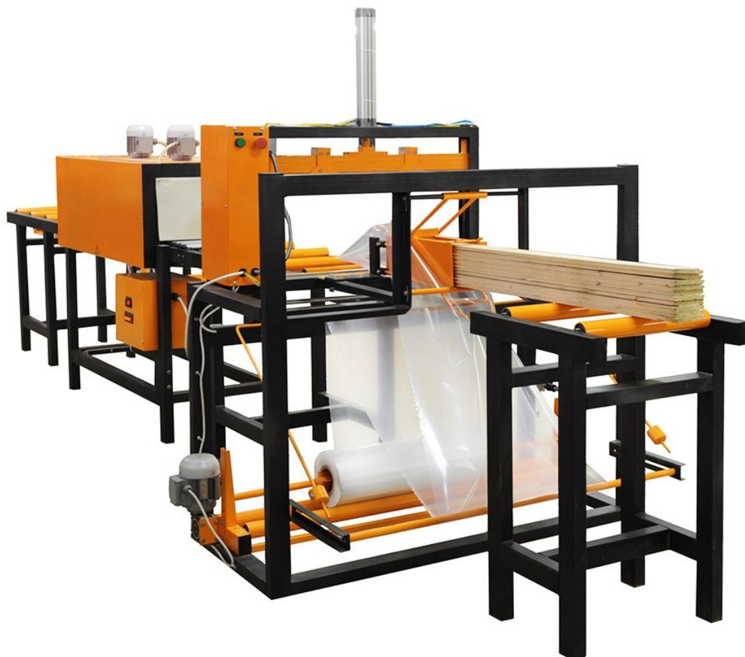
Термоупаковочная машина ТМ-5П предназначена для штучной и групповой упаковки длинномеров: вагонки, бруса, плинтусов, досок, карнизов и т.п.
