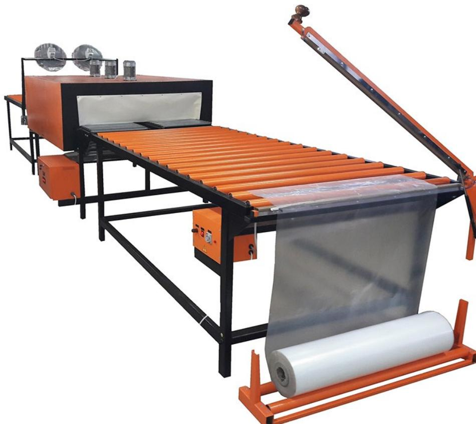
Термоупаковочная машина ТМ-7Р М1 (ручная) предназначена для упаковки длинномерных изделий, к числу которых относятся различного вида пиломатериалы: доска, двери, короба, и т.п. в термоусадочную полиэтиленовую пленку.
