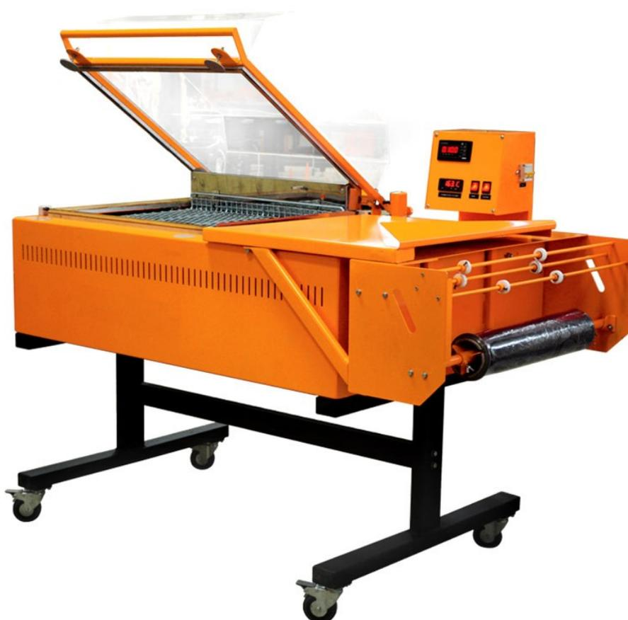
Термоупаковочная машина ТМ-8 М1 (ручная) предназначена для автоматической групповой упаковки в термоусадочную пленку пищевой, косметической или иной продукции в стеклянной, металлической, бумажной или пластиковой таре.
