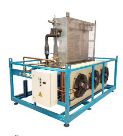
Испаритель панельный пленочный на 4 плато-места с площадью поверхности теплообмена 9 м кв. Предназначен для охлаждения воды и других жидкостей, используемых далее в технологических процессах на предприятиях пищевой промышленности (молочные, пивоваренные, птице-, мясо-, рыбо- перерабатывающие заводы), химической промышленности. Основная область применения: охлаждение воды до температур, близких к 0°C, без риска размораживания теплообменного аппарата.
