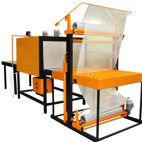
Термоупаковочная машина ТМ-1Р М1 предназначена для упаковки утеплителя, коробов больших размеров, пенопласта, бухт кабелей в термоусадочную полиэтиленовую пленку.
