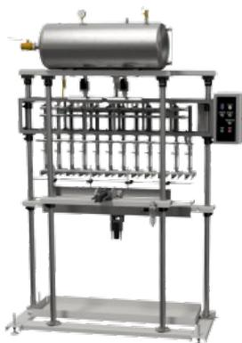
Автомат предназначен для фасования газированных напитков в бутылки из полиэтилентерефталата (ПЭТ-тару). Дозация продукта производится по уровню методом перелива.
