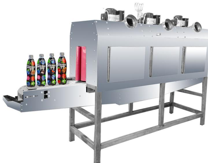
Термоусадочный аппарат ТМ-10 «ПТ» (паровой тоннель) предназначен для усадки (фиксации) термоусадочной рукавной этикетки (слив-этикетки, sleeve) на поверхность тары с готовой продукцией. В качестве теплоносителя используется горячий водяной пар.
