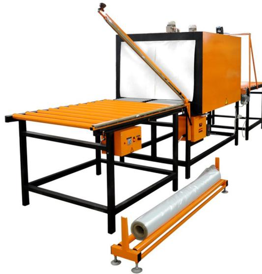
Термоупаковочная машина ТМ-7Р М2 (ручная) предназначена для упаковки длинномерных изделий, к числу которых относятся различного вида пиломатериалы: доска, двери, коробка, и т.п. в термоусадочную полиэтиленовую пленку.
