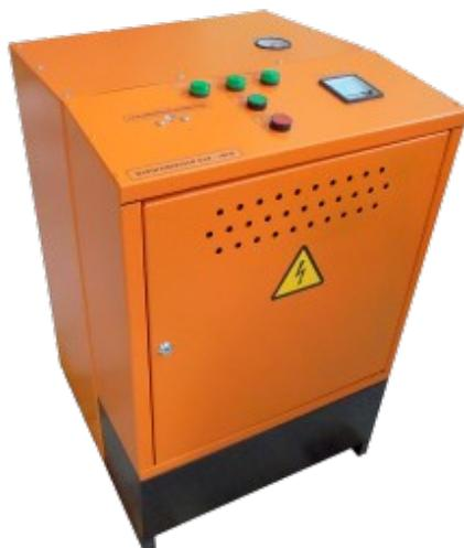
Парогенератор электрический электродный предназначен для выработки насыщенного водяного пара с температурой 130-160 °С и давлением до 0,55 МПа за счет теплоты, выделяющейся в результате использования электроэнергии.
