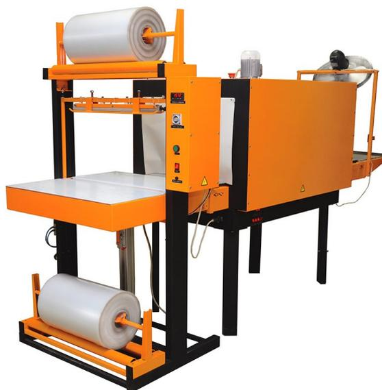
Термоупаковочная машина ТМ-1ПН (пневмонож) предназначена для упаковки пищевой, косметической или иной продукции в стеклянной, металлической, бумажной или пластиковой таре.
