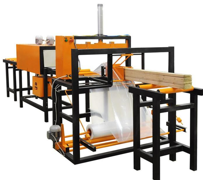
Термоупаковочная машина ТМ-5П предназначена для штучной и групповой упаковки длиномеров: вагонки, бруса, плинтусов, досок, карнизов и т. п.
