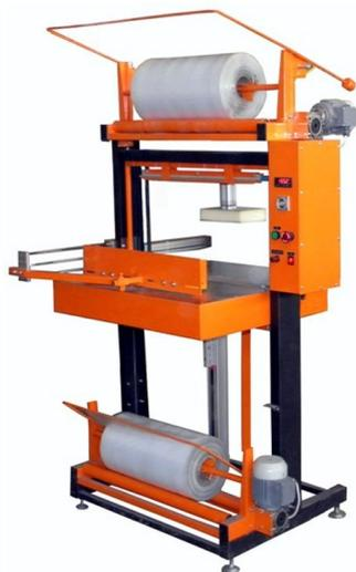
Термонож пневматический ТМ-1П предназначен для штучной и групповой упаковки различных видов продукции в полиэтиленовую термоусадочную пленку. Толкатель термоножа регулируется под габариты продукции, что дает возможность увеличить перечень упаковываемого товара.
