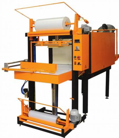
Термоупаковочная машина ТМ-1П (полуавтомат) предназначена для упаковки пищевой, косметической или иной продукции в стеклянной, металлической, бумажной или пластиковой таре.
