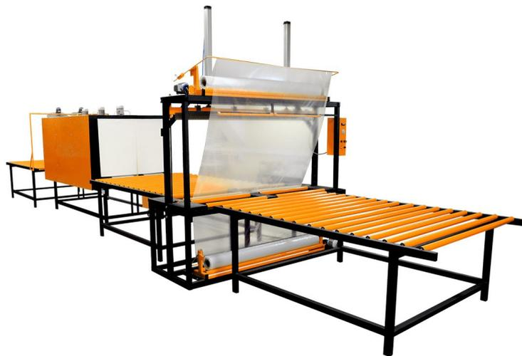
Термоупаковочная машина ТМ-1ПН М3 (пневмонож) предназначена для упаковки товара с максимальным размером ДхШхВ 2150х760х700 в термоусадочную полиэтиленовую пленку.
