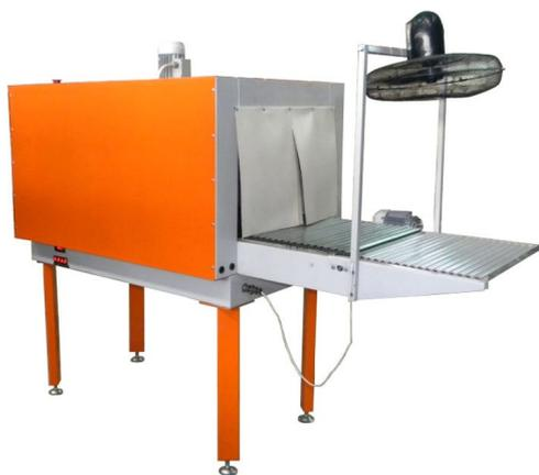
Термокамера ТМ-1 предназначена для штучной и групповой упаковки различных видов продукции в полиэтиленовую термоусадочную пленку, промышленных и пищевых изделий, рыбы, хлеба, мяса, сувениров, фруктов, овощей, кондитерских изделий, полиграфии, парфюмерии, бытовой химии.
