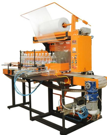
Термонож ТМ-1А предназначен для автоматической групповой упаковки в термоусадочную полиэтиленовую пленку пищевой, косметической или иной продукции в стеклянной, металлической, бумажной или пластиковой таре: банок, бутылок, канистр, коробов, пакетов и т.п.
