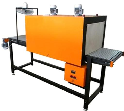
Термотоннель ТМ-1А предназначен для автоматической групповой упаковки в термоусадочную полиэтиленовую пленку пищевой, косметической или иной продукции в стеклянной, металлической, бумажной или пластиковой таре: банок, бутылок, канистр, коробов, пакетов и т.п. за счет двухсекционной компоновки.
