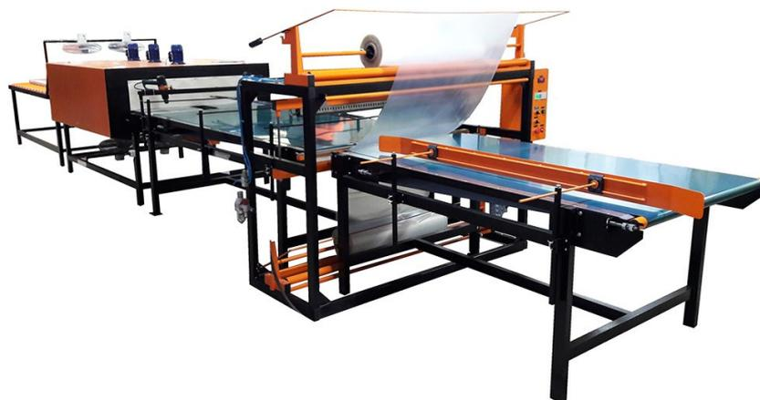
Термоупаковочная машина ТМ-7А (Автоматическая) предназначена для упаковки длинномерных изделий, к числу которых относятся различного вида пиломатериалы: доска, двери, коробка, и т.п. в термоусадочную полиэтиленовую пленку.
