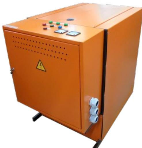
Парогенератор электрический электродный предназначен для выработки насыщенного водяного пара с температурой 130-160 °С и давлением до 0,55 МПа за счет теплоты, выделяющейся в результате использования электроэнергии.
