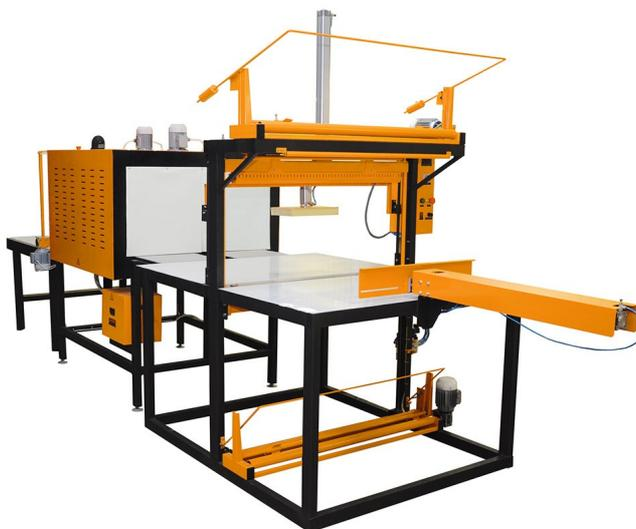
Термоупаковочная машина ТМ-1П М1 предназначена для упаковки коробов больших размеров, утеплителя, пенопласта, бухт кабелей в термоусадочную полиэтиленовую пленку.
