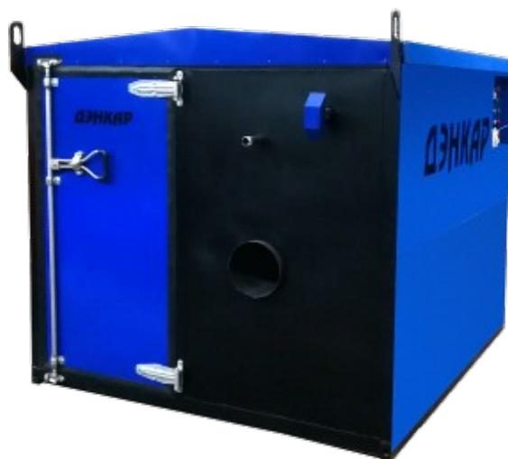
Парогенератор мобильный ПГМ-0,2 изготовлен в виде теплоизолированного контейнера, который оснащен баком для питательной воды и дизельного топлива. Объем баков рассчитан на непрерывную работу парогенератора в течение 3-4 часов без дозаправки.
