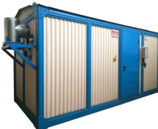
**Установка производства пара УПП-0,5 Ж** — это устройство, производящее пар при помощи нагрева при сгорании дизельного топлива, которое используется при производстве бетона в зимнее время на бетонных заводах и БСУ. Данная установка работает в автоматическом режиме и не требует постоянного присутствия персонала. Автоматическая система управления осуществляет контроль над уровнем воды в котле, давлением.
