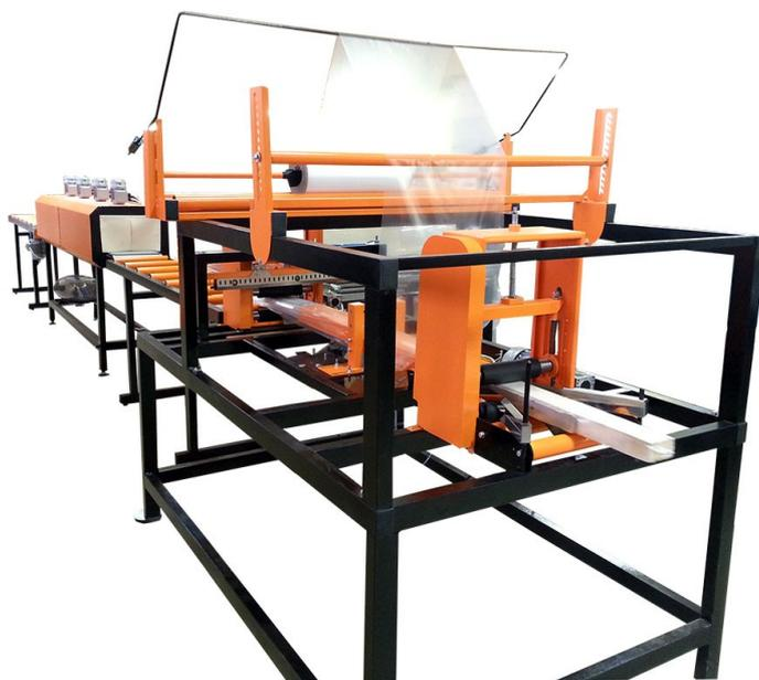
Термоупаковочная машина ТМ-5А (Автоматическая) предназначена для упаковки в термоусадочный полиэтилен длинномерной продукции. Это могут быть пиломатериалы, строительные и ремонтные материалы и изделия, металлические длинномеры, части мебели.
