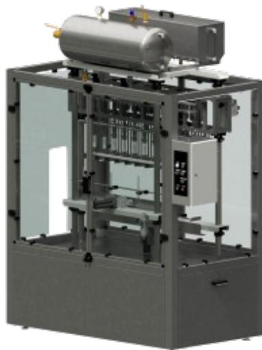
Автомат предназначен для розлива воды и напитков с сиропом в бутылки из полиэтилентерефталата (ПЭТ-тару). Дозация продукта производится по уровню методом перелива.
