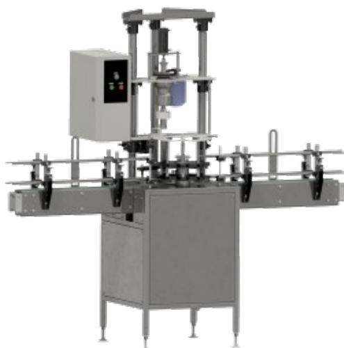
Машина предназначена для закупоривания ПЭТ бутылок (0.25-2л) винтовой пластмассовой пробкой.
