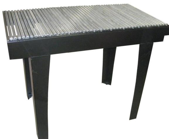
Приемный рольганг ТМ-1А предназначен для перемещения различной по весу и размерам упакованной продукции.
